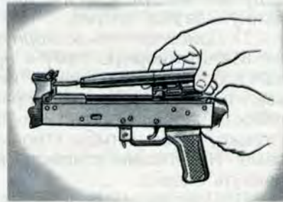
Рис. 22. Отделение затворной рамы с затвором
