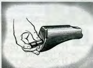
Рис. 25. Вкладывание пенала в гнездо приклада
