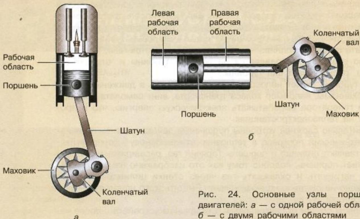
Рис. 24. Основные узлы поршневых двигателей: а — с одной рабочей областью; б — с двумя рабочими областями
