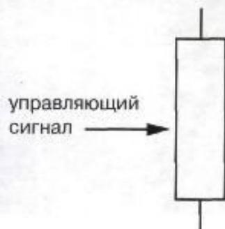
Рис. 66. Управляемое сопротивление, эквивалентное транзистору
