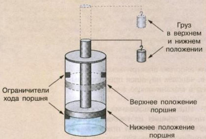
Рис. 20. Простейший вымышленный тепловой двигатель
