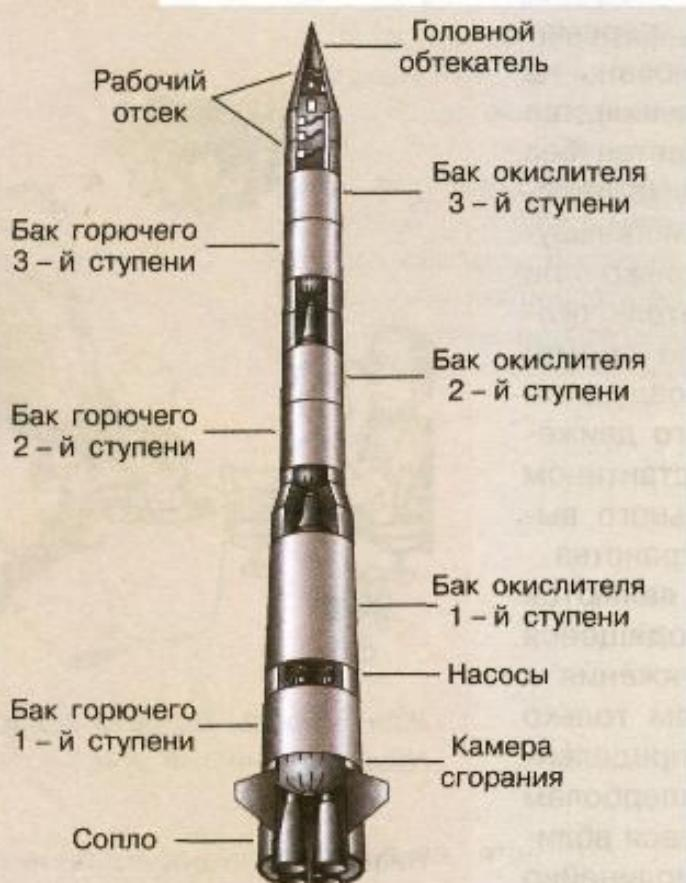
Рис. 17. Схема космического реактивного двигателя
