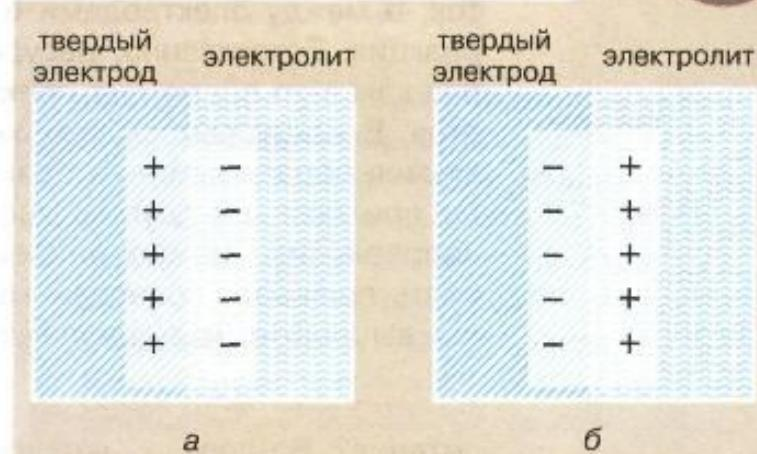
Рис. 30. Варианты распределения зарядов на границе между электролитом и электродом
