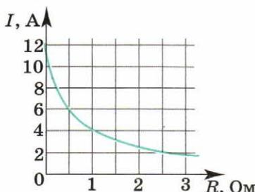
**A2.** К источнику тока с внутренним сопротивлением 0,5 Ом подключили реостат. На рисунке показан график зависимости силы тока в реостате от его сопротивления. Чему равна ЭДС источника тока?
