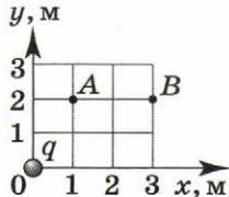
**C2.** Точечный заряд  $q$ , помещённый в начало координат, создаёт в точке  $A$  электростатическое поле напряжённостью  $E_A = 65$  Н/Кл (см. рис.). Чему равна напряженность  $E_B$  в точке  $B$ ?
