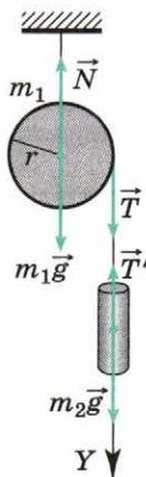
**Задача 1.** На блок радиусом  $r$  и массой  $m_1$  намотана нить, к концу которой привязан груз массой  $m_2$  (рис. 6.12). Груз отпускают, и он движется вниз, раскручивая нить. Определите ускорение груза. Массой нити можно пренебречь.
