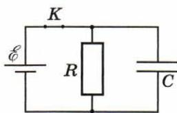
**С5.** В электрической схеме, показанной на рисунке, ключ  $K$  замкнут. Заряд конденсатора  $q = 2\text{ мкКл}$ , ЭДС батарейки  $\mathcal{E} = 24\text{ В}$ , её внутреннее сопротивление  $r = 5\text{ Ом}$ , сопротивление резистора  $R = 25\text{ Ом}$ . Определите количество теплоты, которая выделяется на резисторе после размыкания ключа  $K$  в результате разрядки конденсатора. Потерями на излучение можно пренебречь.
