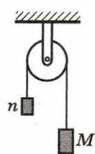
A2. Брусков массой  $M = 300$  г соединён с бруском массой  $m = 200$  г невесомой и нерастяжимой нитью, перекинутой через невесомый блок (см. рис.). Чему равен модуль ускорения бруска массой 200 г?
