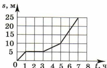
2. На рисунке 1.17 изображён график зависимости координаты от времени для точки, движущейся вдоль оси  $OX$ . Опишите движение точки в интервалах времени от 0 до 3 с, от 3 до 7 с и от 7 до 9 с. Постройте графики модуля и проекции скорости в зависимости от времени. Начертите график зависимости пути от времени.
