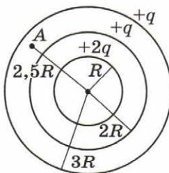
**C4.** Три концентрические сферы радиусами  $R$ ,  $2R$  и  $3R$  (см. рис.) имеют равномерно распределённые по их поверхностям заряды  $q_1 = +2q$ ,  $q_2 = +q$ ,  $q_3 = +q$  соответственно. Известно, что точечный заряд  $q$  создаёт на расстоянии  $R$  электрическое поле с потенциалом  $\varphi_1 = 100$  В. Чему равен потенциал в точке  $A$ , отстоящей от центра сфер на расстоянии  $R_A = 2,5R$ ?
