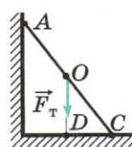
**A3.** На рисунке схематически изображена лестница  $AC$ , опирающаяся на стену. Чему равен момент силы трения, действующей на лестницу, относительно точки  $D$ ?
