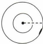
**A4.** На рисунке показана схема опыта Штерна по определению скорости молекул. Пунктиром обозначена траектория атомов серебра, летящих от проволоки в центре установки через щель во внутреннем цилиндре к внешнему цилиндури при неподвижных цилиндрах. Чёрным отмечено место, куда попадали атомы серебра при вращении цилиндров. Какое утверждение верно? Пятно образовалось, когда
