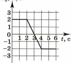
**A1.** На графике изображена зависимость проекции скорости точки, движущейся вдоль оси  $OX$ , от времени. Чему равен модуль перемещения точки к моменту времени  $t = 6$  с?
