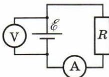
**A5.** Вольтметр и амперметр, включённые в электрическую цепь (см. рис.), показывают соответственно 9 В и 3 А. Сопротивление нагрузки в 5 раз больше внутреннего сопротивления источника тока. Чему равно сопротивление внешней цепи? Вольтметр и амперметр считайте идеальными.
